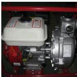
Тип насоса: центробежный с радиальным потоком, одноступенчатый, одно входное рабочее колесо
